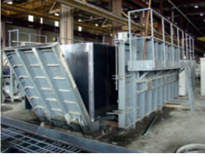
Şek. 5, 6 ve 7: Toyota'nın iç çekirdeğin parçalanmadığı kalıp sistemi
